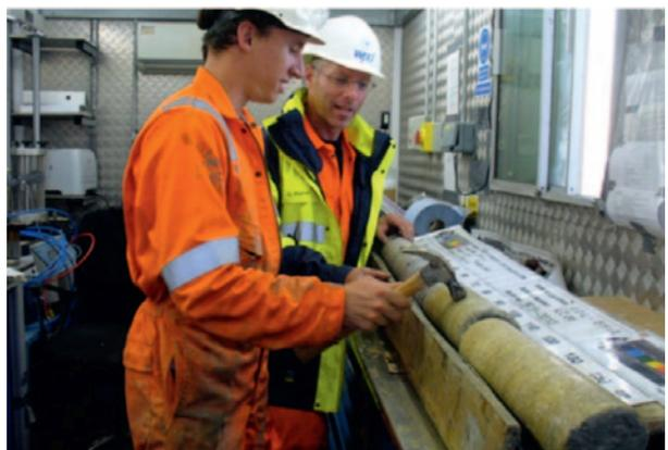
En 2011, trois carottages de 40 mètres de profondeur ont été réalisés afin de mieux identifier les caractéristiques du sous-sol calcaire et de pouvoir déterminer le type et le dimensionnement des fondations des éoliennes. D'autres forages sont prévus en 2013 et 2014 pour affiner la connaissance du sous-sol marin.
