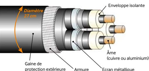
Pour la partie sous-marine, les trois câbles de chaque circuit sont regroupés dans une gaine protectrice, constituant ainsi un câble tripolaire d'un diamètre d'environ 27 cm.
